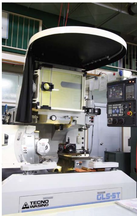
プロフィール研磨機による複合形状加工 ツールの製作
