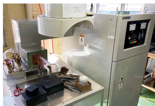
高周波誘導加熱装置 熟練の職人技術によるロウ付加工
