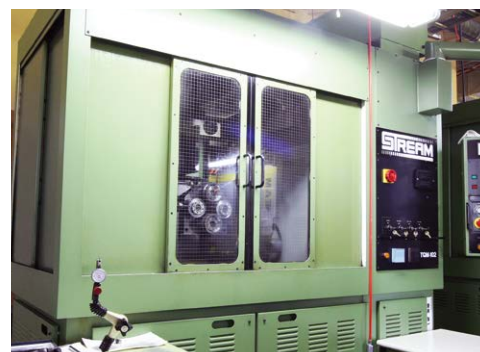
STREAM/ エワーグ設備による刃径 0.2 から刃径公差 \pm 0.001 の細物ツールの製作
